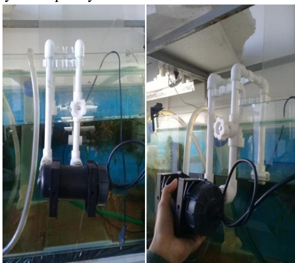
Рисунок 3 –Использование УФ - стерилизатора с насадкой из полипропиленовых труб в аквариальной БГСХА
