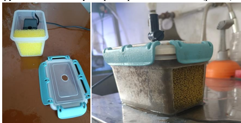
Рисунок 6 – Защитное устройство для водяной помпы
