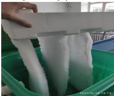
Рисунок 2 - Синтепон в качестве субстрата для нитрофицирующих бактерий в биофильтре для мини-УЗВ
